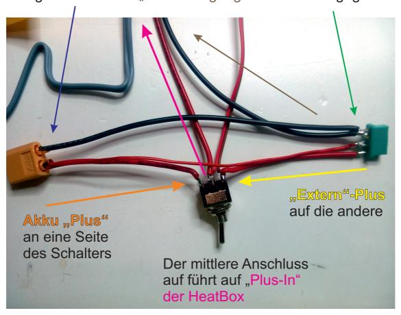
Die zusätzliche, dünnere rote Leitung verbindet den Akku-"Plus" mit einem freien Kontakt an der Extern-Buchse. Ist der Schalter in **Mittelstellung** (WICHTIG!) kann über die Buchse der Akku geladen werden.
